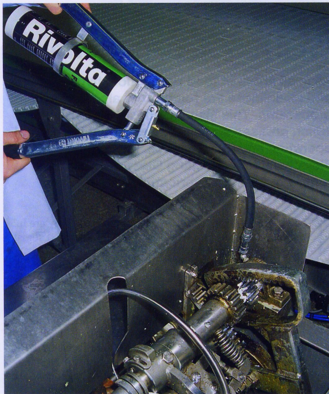
Die HD-Zweihandpresse mit dem NSF-H1 gelisteten, vollsynthetischen Wälz- und Gleitlagerfett Rivotla® F.L.G. 4-2 im Einsatz. The two-hand HP grease gun with the NSF-H1 listed, fully synthetic roller bearing and plain bearing grease Rivotla® F.L.G. 4-2 in use.
