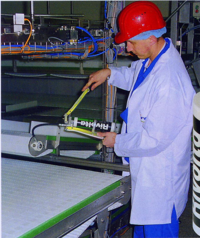
Nutzung der patentierten HD-Zweihandpresse zum Abschmieren eines Zerlegebands./ Application of the patented two-hand HP grease gun to lubricate a butchering belt.
