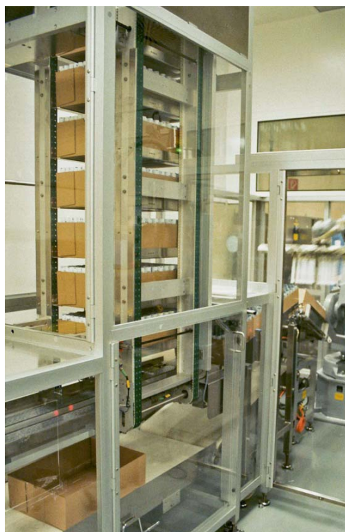
Zur Zuführung der Leertuben wurde ein spezielles Paternoster-system konstruiert.
