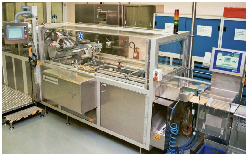
Die Tubenfüllanlage NM 2002 arbeitet in Kombination mit einem Robot-Tube-Loader.
