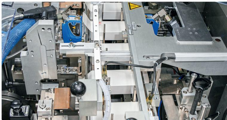
Zwei vollisolierte pneumatische Heißleim-Auftragsköpfe des Typs MiniBlue II setzen jeweils zwei Klebepunkte auf die Einstecklaschen der Faltschachteln.
