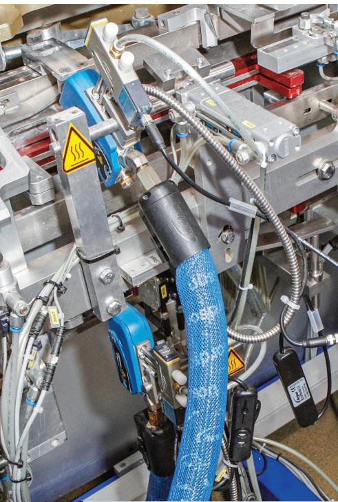
Zwei pneumatische Applikatoren des Typs MiniBlue II bewerkstelligen den Auftrag des Heissleims, dessen Verbrauch durch die beiden rechts unten im Bild erkennbaren EcoBead-Controller erheblich reduziert wird.
