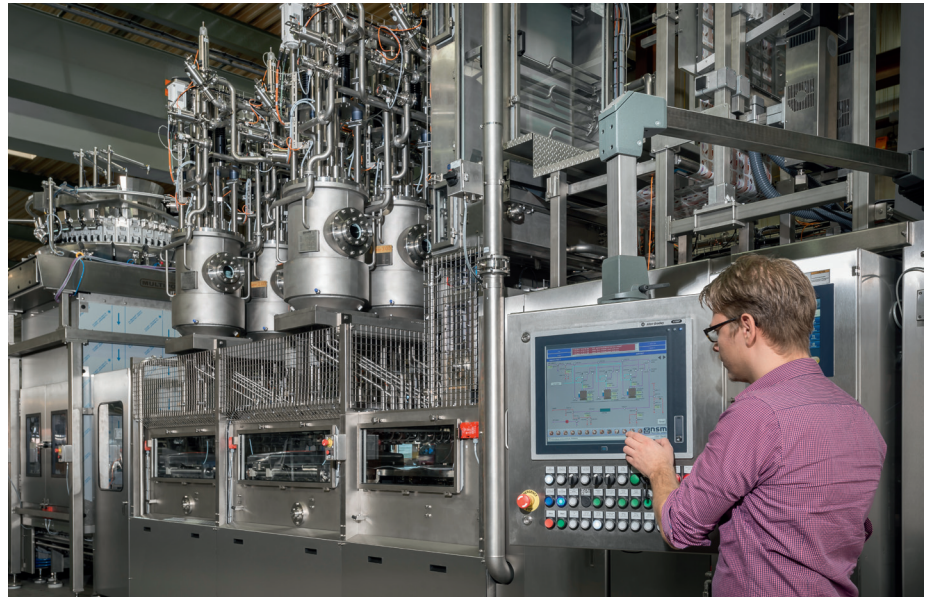
Teilansicht einer aseptischen Form-, Füll- und Verschleißmaschine von Finnah Packtec, die Präzisionstechnik mit hohem Bedienkomfort vereint (Foto: Finnah Packtec)
