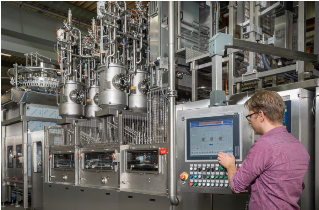
Teilansicht einer aseptischen Form-, Füll- und Verschleißmaschine von Finnah Packtec, die Präzisionstechnik mit hohem Bedienkomfort vereint.
