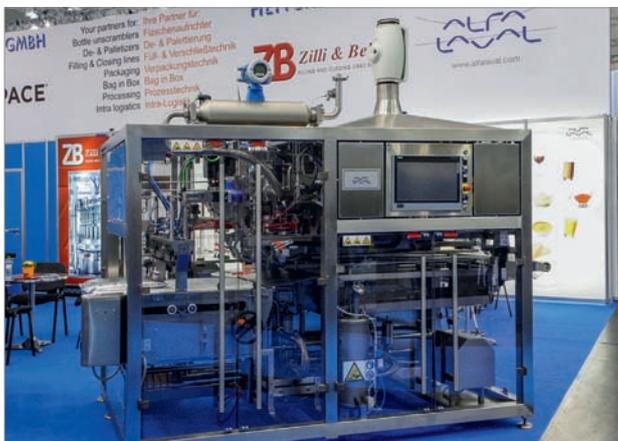
Abb. links: Aseptischer Bag-in-Box-Füller Astepo HS-LA von Alfa Laval
