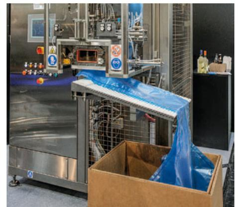
Manueller Aseptikfüller: Die durchschnittliche Leistung wird mit 100 bis 160 Gebinden pro Stunde angegeben.
