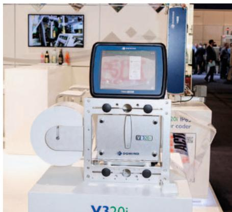
Thermotransfer-Direktdrucker V320I: Die Kennzeichnung erfolgt direkt nach der Folienspreizung.
