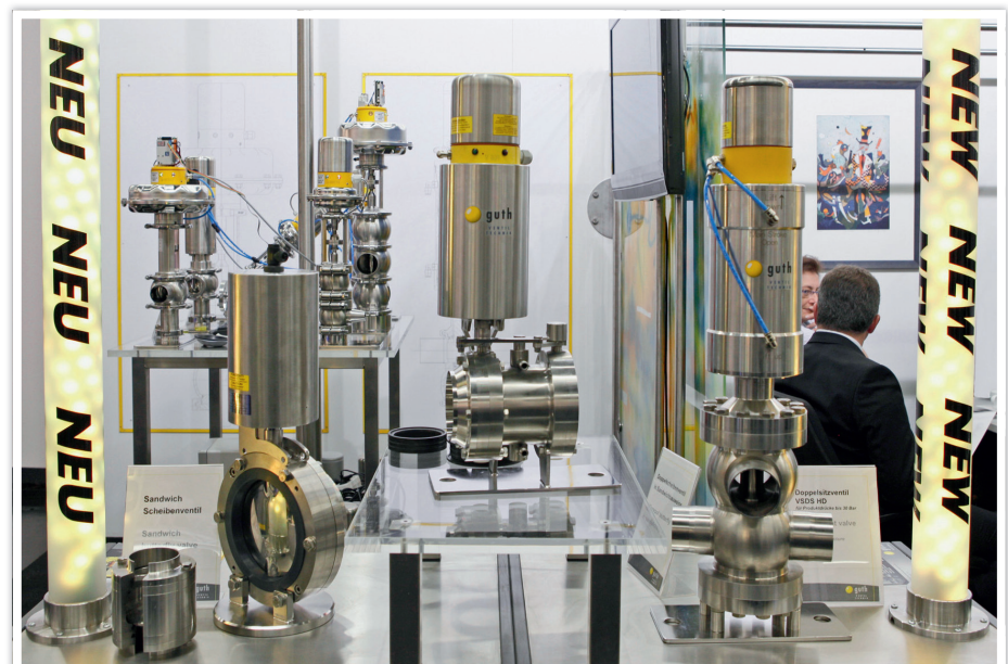
Guth Ventiltechnik zeigte u.a. Leckage-Doppelscheibenventile in neuer Sandwich-Bauweise
