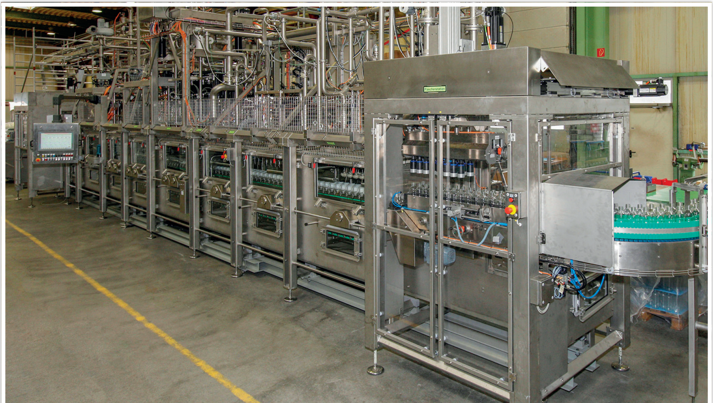
Die neue Flaschenfüll- und -verschließmaschine FF 5100-4/4 in der Gesamtansicht
