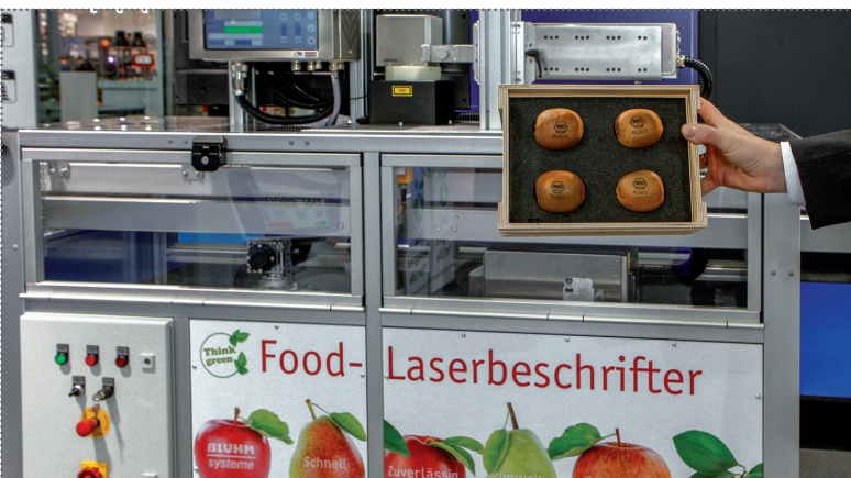
Mit dem CO 2 -Laser e-SolarMark von Solaris, der in der D-A-CH-Region von Bluhm Systeme vertrieben wird, ist auch die direkte Kennzeichnung von Früchten möglich
