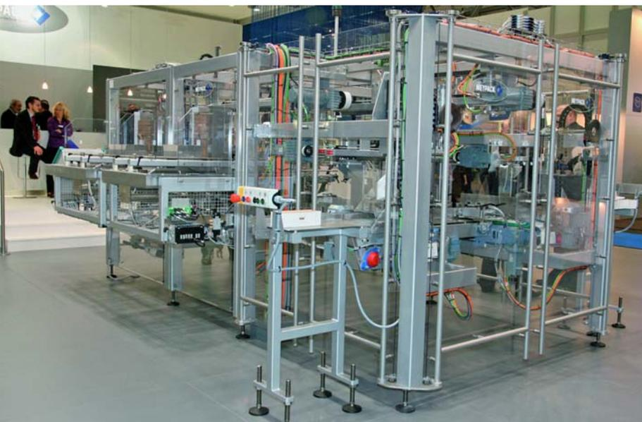
Bei der Meypack Verpackungssystemtechnik GmbH, Nottuln, stand eine Kartonverpackungsanlage des Typs VP 452 im Mittelpunkt, welche die Endverpackung kleiner Faltschachteln in Deckel-Trays demonstrierte.
