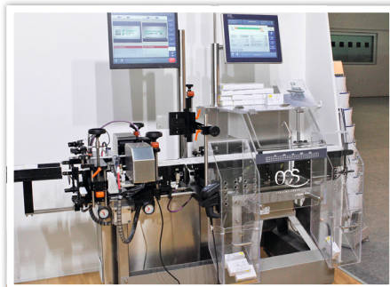
Von OCS Checkweighers, REA Elektronik und der schweizerischen QualiVision AG gemeinschaftlich realisiertes Komplettsystem zum Serialisieren, Bedrucken, Kontrollieren und Wiegen von Faltschachteln
