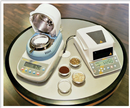
Feuchtebestimmungsgeräte DLB (links) und DBS von Kern (Foto: Bernd Neumann)
