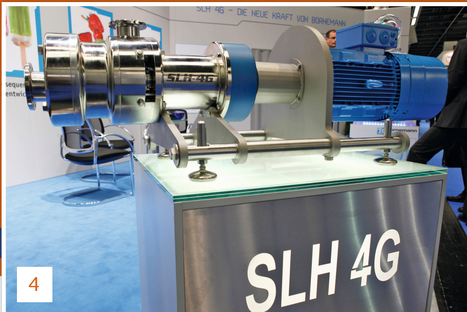
1. Mit neuem Grundrahmen ausgestattete Drehkolbenpumpe Noalobe von Grundfos-Hilge 2. Exzentrerschneckenpumpen-Baureihe JP-700 von Jessberger 3. Edelstahl-Kreiselpumpe des Typs 80-160 der Serie MCP3 von Packo Inox 4. Zweispindelige Schraubenspindel-pumpe SLH 4G 3000 von Bornemann 5. Mehrfach als lebensmittelkonform zertifizierte Food-Baureihe von Flux 6. Doppelflutige Schraubenspindel-pumpe Hyghspin 90 DF von Jung Process Systems
