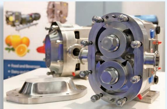
Mit neuem Grundrahmen ausgestattete Drehkolbenpumpe Novalobe von Grundfos-Hilge.
