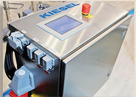
Kombiregelung für die Exzenterschneckenpumpen von Kiesel
