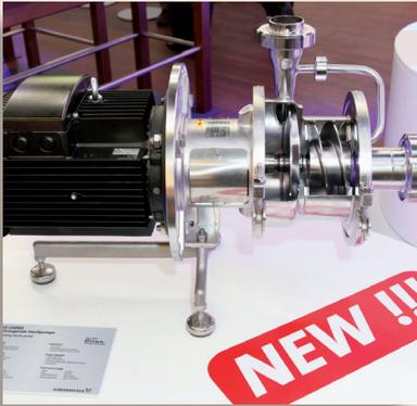
Selbstansaugende Sterilpumpe der GHP-Baureihe von Grundfos Hilge
