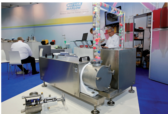
Sinuswellenpumpe SPS-2,5" von Watson Marlow MasoSine (alle Fotos: Kimberly Wittlieb).
