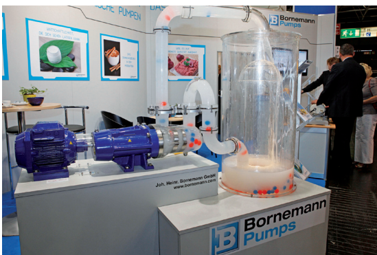
Schraubenspindelpumpe des Typs SLH von Bornemann.
