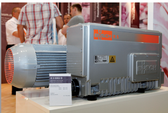
Ölumlaufgeschmierte Drehschieber-Vakuumpumpe R5 302 D von Busch.
