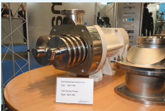
Zwei-spindelige Schraubenspindelpumpe SLH 180 von Bornemann.
