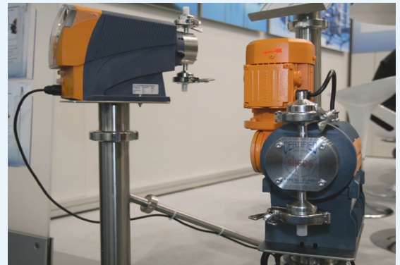
Exzentrerschneckenpumpe KB-SL Hygienic der Pumpenfabrik Wangen.
