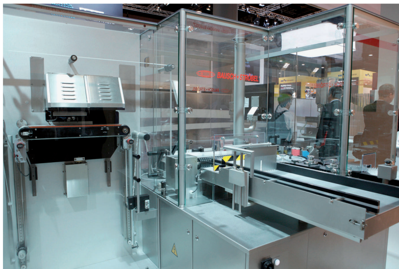
Komplettes Etikettiercenter von Bausch + Ströbel mit digitalem Hapa-Druckwerk.
