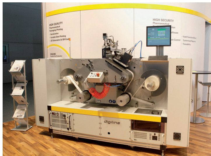
Das Codier- und Drucksystem Digiline von Atlantic Zeiser ist auch für Booklet-Etiketten konzipiert.
