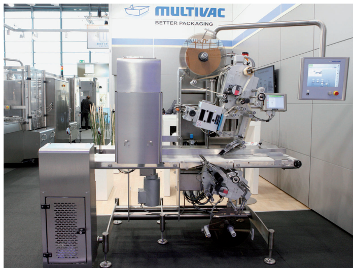
Transportbandetikettierer MR335 SQ von Multivac Marking & Inspection mit integriertem Vision System.
