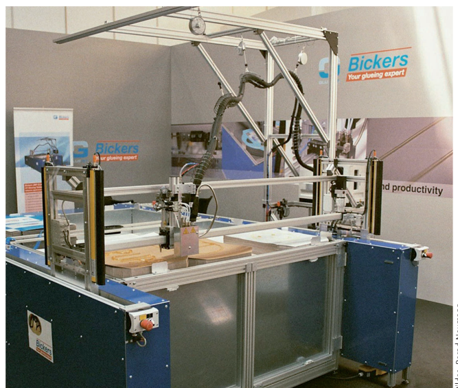
Der XY-Klebetisch von Bickers verfügt über einen hydraulischen Hubtisch bis 850 mm Stapelhöhe
