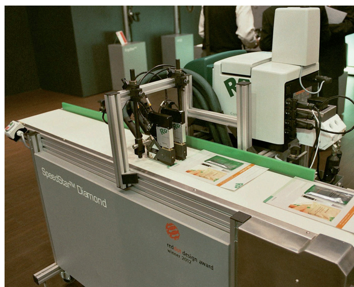
Die elektro-mechanischen Heißleim-Auftragsköpfe Speedstar Diamond von Robatech ermöglichen sowohl einen Punkt- oder einen Raupenauftrag in der Endverpackung
