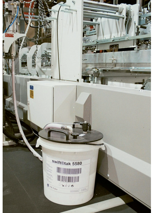
Die von H.B.Fuller/Forbo zur Herstellung von Faltkartons entwickelte Klebstoffsorte Swift tak 5580 wurde in Düsseldorf an einer Bobst-Linie mit Baumer hhs-Auftragssystem demonstriert
