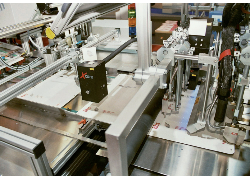
Für den Punkt- und Strichauftrag konstruierte elektrische Kaltleimventile P-600 von Baumer hhs mit nachgeschaltetem Kamera-Inspektionssystem XCam
