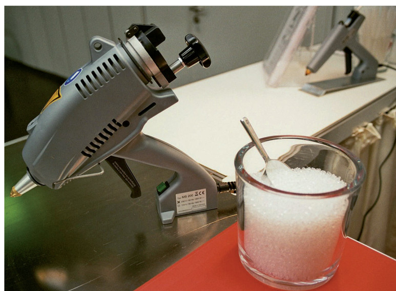
Mit der ohne Druckluft arbeitenden Klebepistole MS 200 von Reka können sowohl Granulate als auch Sticks und Pillows verarbeitet werden
