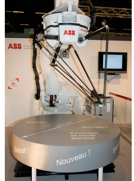
Rechts: Der weiterentwickelte Roboter FlexPicker IRB 360 mit nunmehr 1.600 mm Aktionsradius stand bei ABB im Mittelpunkt.
