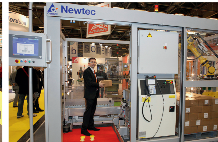
Ein über Laserscanner gesteuertes neuartiges Sicherheitskonzept ermöglicht beim neuen PR-Roboter-Palettierer von Cermex/Newtec die interaktive Kommunikation zwischen Roboter und Bediener, sobald dieser die Palettierzelle betritt.
