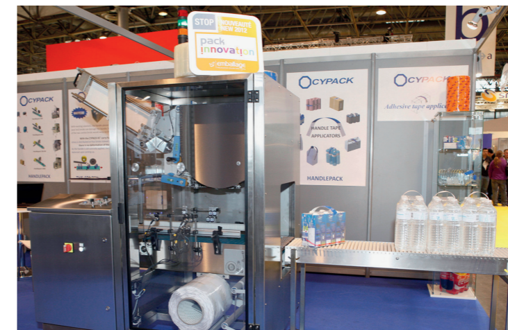
Mit der patentierten Handelpack 450 von Cypack können Tragegriffe auch in einem 45-Grad-Winkel angebracht werden.
