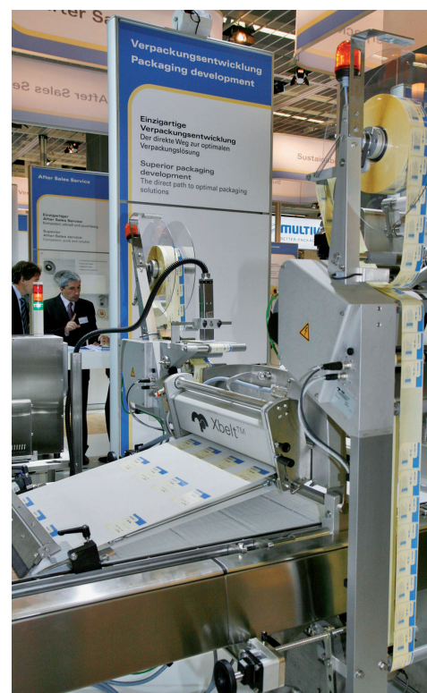
Patentierter Querbahnetikettierer Xbelt von MR Etikettier-technik.
