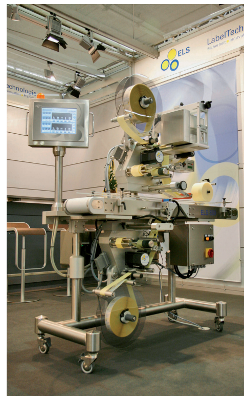
Von oben und unten spendender Transportbahnetikettierer des Typs 330 von ELS.
