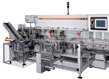
**LTM-DUO Falteinschlagmaschine für Schokoladetafeln in neuer Ausführung mit einer Kapazität bis zu 180 Packungen/Min.**
