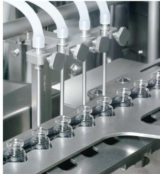
**Die FVF 5061 ist mit einem Isolator ausgerüstet, verfügt über eine hundertprozentige IPC-Kontrolle sowie eine CIP/SIP-Ausrüstung und arbeitet mit einer Leistung bis zu 12 000 Stück/h.** Bild: Bausch + Ströbel
