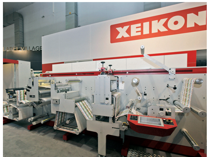
Digitale Druckmaschine Xeikon 3500 mit in- tegrierter UV-Lackier-, Laminier-, Schneide- und Aufroll-Station DCoat 500.
