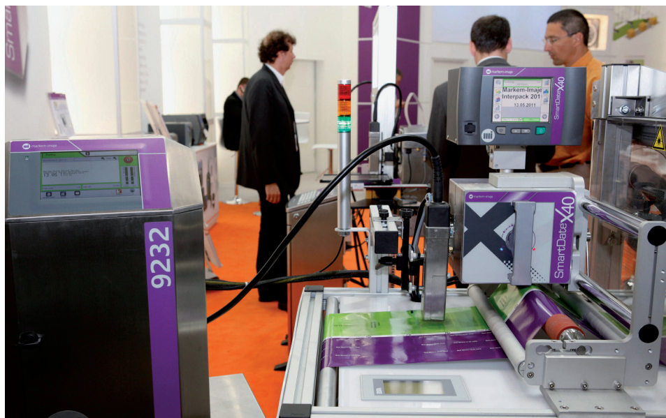
Der Tintenstrahldrucker 9232 (links) und der Thermotransferdrucker SmartDate X40 von Markem-Imaje.
