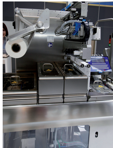
Foliendirektdrucker MR 296 TI vom Multivac Marking & Inspection mit Druckwerk m600 von Wolke
