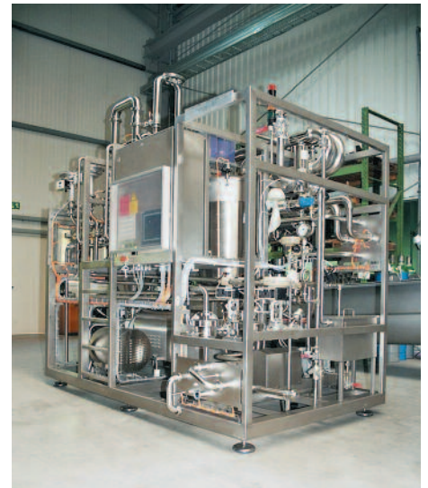
Eine weitere KS-Eigenentwicklung sind UHT-Anlagen mit Zweikreisssystem
