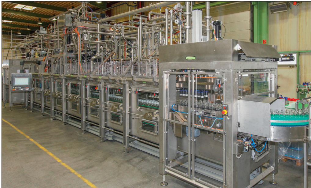
Die neue Flaschenfüll- und -verschließmaschine FF 5100-4/4 in der Gesamtansicht (Fotos: Kimberly Wittlieb)
