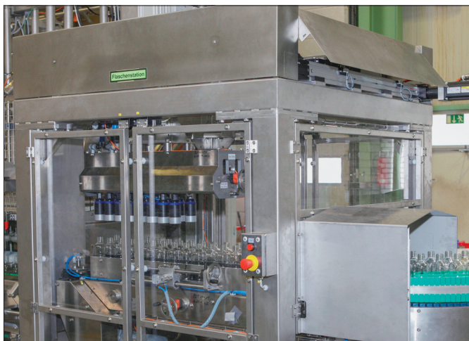
Im Einlauf werden die Flaschen mit Hilfe von Packtulen in stufenlos verstellbare Transportkassetten gesetzt.
