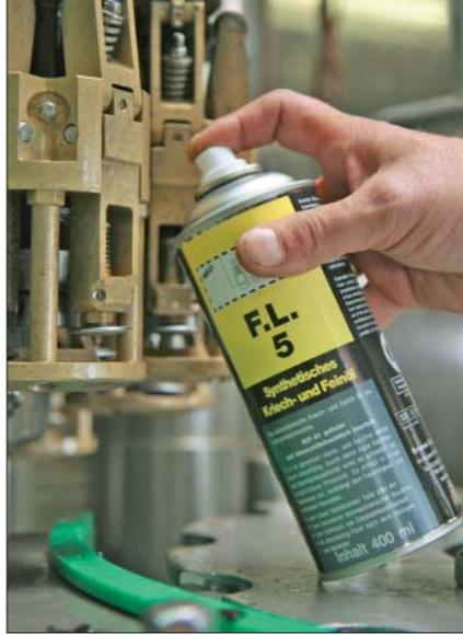
Zum Schmieren der Verschleißerköpfe wird das gleichfalls H1-eingestufte Kriechöl Rivalta® F.L.5 verwendet.
