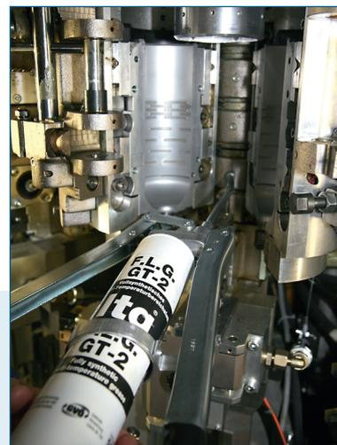
Das Multi-Temperaturbereichsfett F.L.G. GT-2 im Einsatz am Formträger der PET-Blasmaschine
