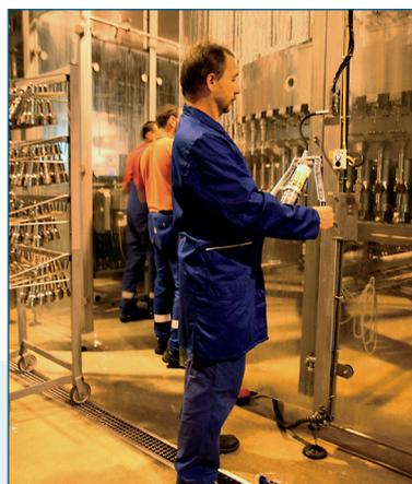
Zum besseren Handling des speziell für Mediendrehverteiler entwickelten Silikonfetts F.L.G. MD-2 wurde als Alternative zur üblichen Zufuhr am Füllerkopf eine spezielle, in Augenhöhe befindliche Zuleitung konstruiert
