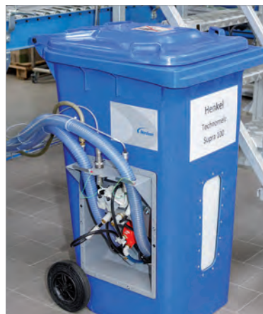
Durch die Multifeeder-Option werden aus der großvolumigen 240-Liter-Vorratsstonne gleichzeitig beide ProBlue Liberty Systeme mit Schmelzklebstoff versorgt.
