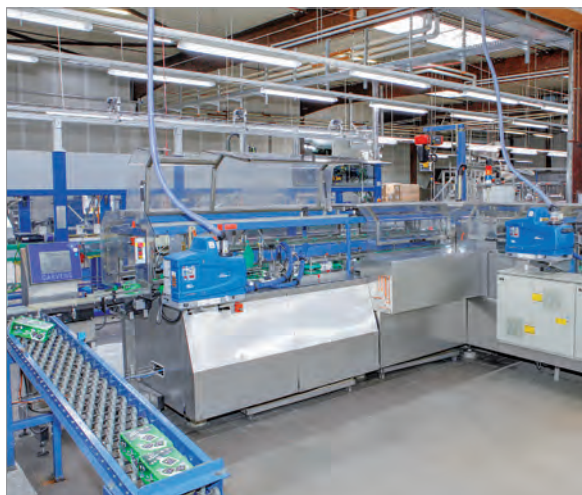
Die Verpackungsmaschine mit den beiden neuen, in Brusthöhe montierten Hotmelt-Auftragssystemen ProBlue Liberty in der Gesamtansicht
