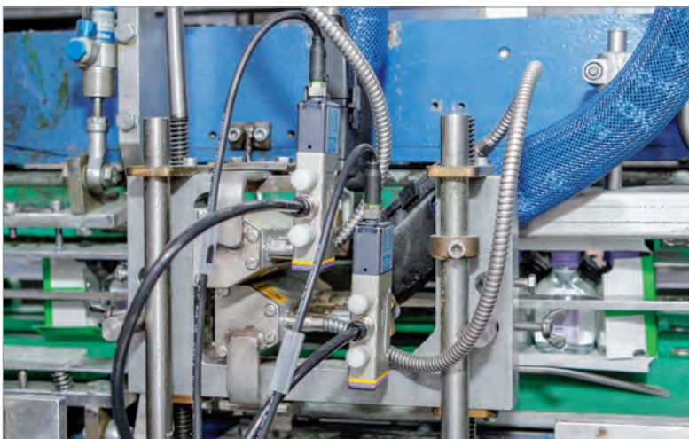
Die Endverklebung der Verkaufskartons geschieht auf beiden Seiten mit Hilfe von zwei mehrmoduligen Auftragsköpfen des Typs MiniBlue II LP.
