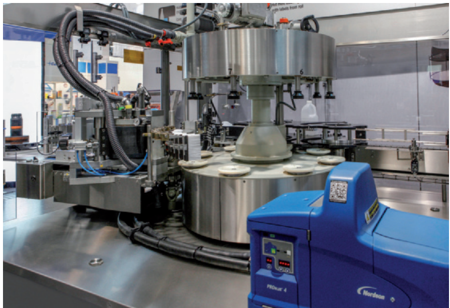
Die Etikettieranlage ist mit acht servomotorisch angetriebenen Flaschentellern ausgerüstet. Das Tankschmelzgerät »ProBlue 4« wurde innerhalb des Maschinengehäuses installiert.
