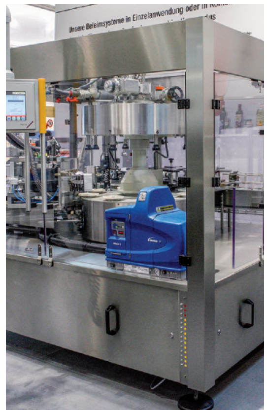
Als Rundläufer kompakt konstruierte Heißbleim-Etikettiermaschine »Rollfed 8-784 1RA SD«.
