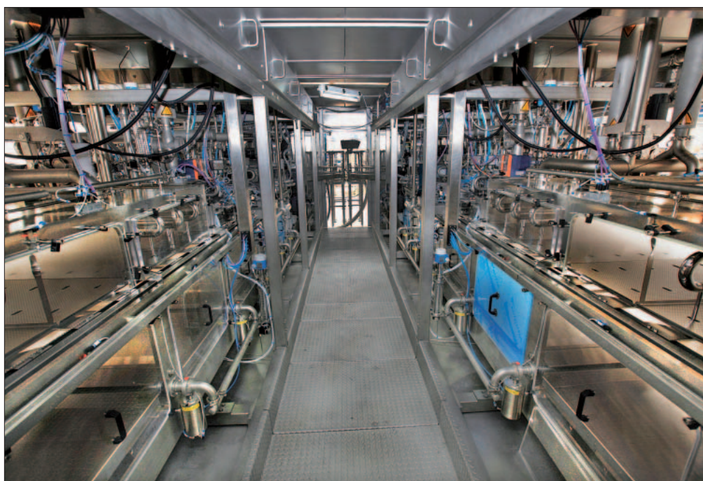
In der Innenansicht – unterhalb des mittig aufgesetzten Ventilknotens – ist der parallele Aufbau der Innosept Asbofill ABF Twin gut erkennbar.
