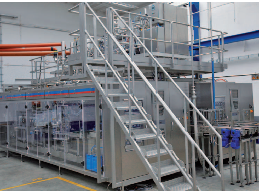
In der Gesamtansicht wird der parallele Aufbau der aseptischen, linear arbeitenden Flaschen-Füll- und -Verschließanlage Innosept Asbofill ABF 711 Twin deutlich. Alle Bilder: Kimberly Wittlieb
