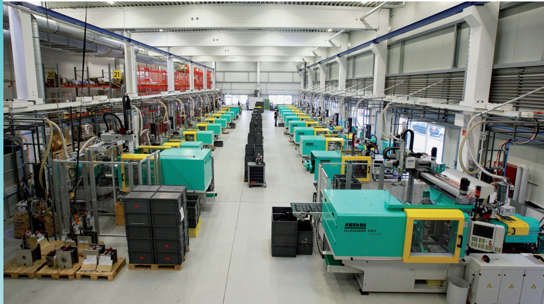
Blick in die moderne Spritzgusshalle der Multi-Contact Essen GmbH mit hydraulischen horizontalen Spritzgießmaschinen von Arburg. Im Spritzgussbereich kommen sieben verschiedene Schmierstoffe und Reiniger zum Einsatz. Bilder: Kimberly Wittlieb
