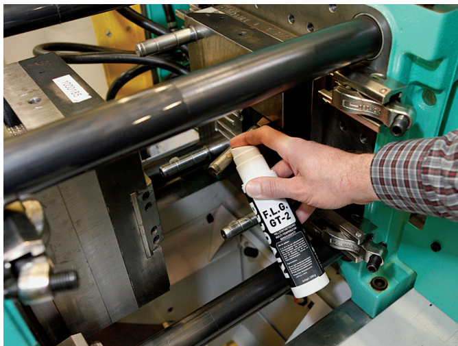
Das vollsynthetische Basisfett F.L.G. GT-2 dient der Schmierung beweglicher Werkzeugeile wie Bolzen, Auswerfer und Schieber.
