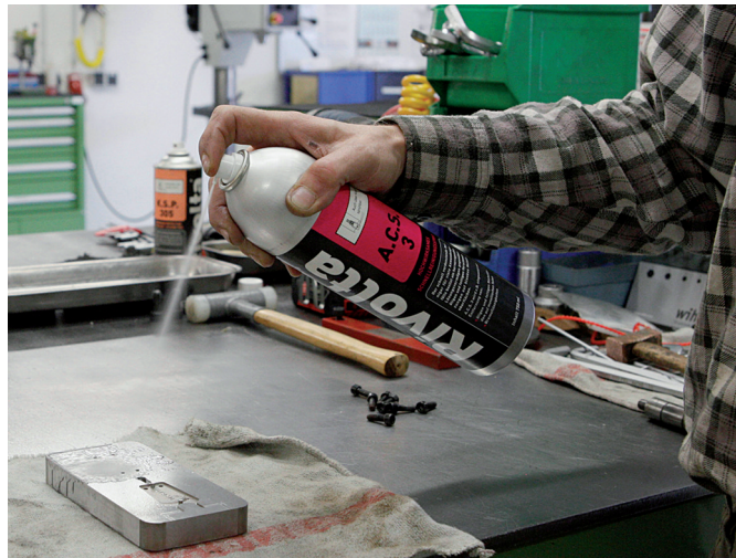
Der Schnellreiniger A.C.S. 3 wird im Formenbau zur Säuberung und Entfettung der Werkzeugoberflächen genutzt.
