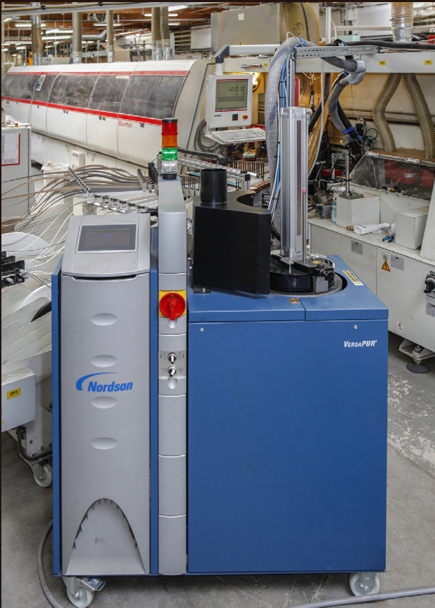
► Eines der beiden in Getmold neu installierten VersaPUR-Schmelzgeräte von Nordson
