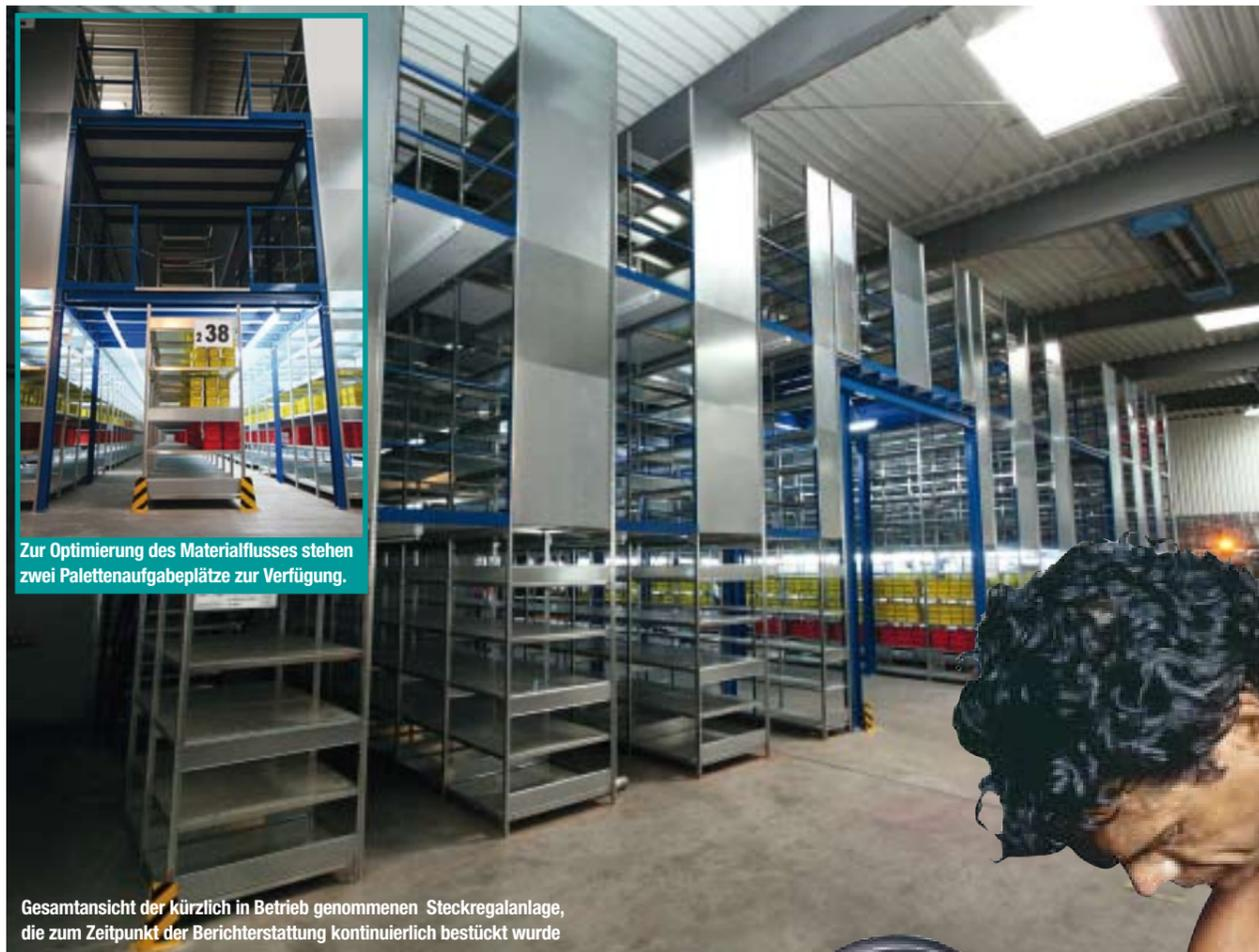
Zur Optimierung des Materialflusses stehen zwei Palettenaufgabeplätze zur Verfügung.
