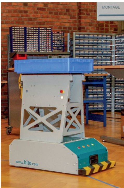
Das fahrerlose Transportsystem Leo Locative
