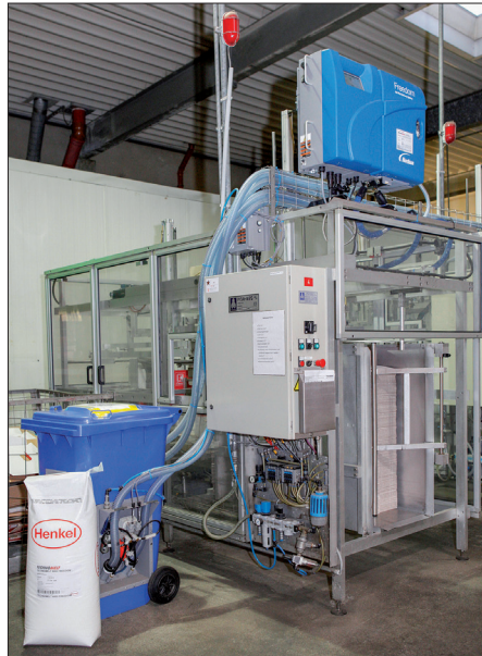
Die 240-Liter-Vorratsbehälter bieten die Möglichkeit einer Mehrfachzuführung, mit der bis zu vier Schmelzgeräte mit Granulat versorgt werden können.
