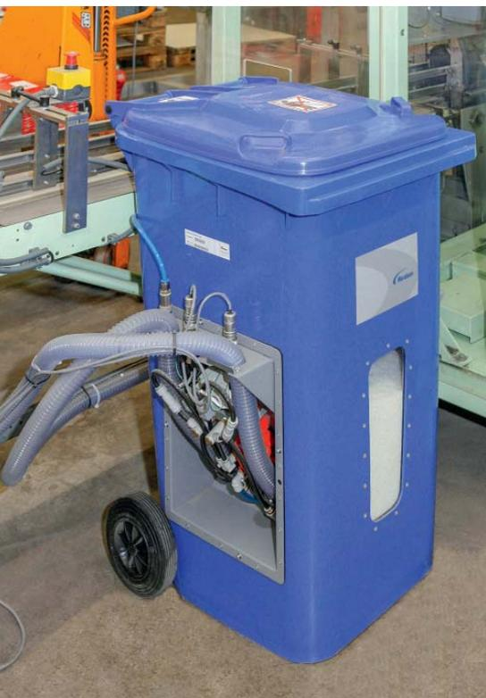
Der 240-Liter-Klebstoffvorratsbehälter ist mit einer Mehrfachzuführungs-Funktion ausgestattet und versorgt gleichzeitig zwei Schmelzgeräte
