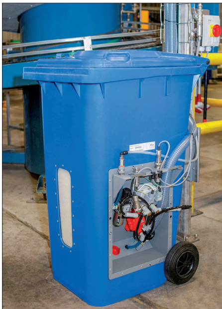
Jeder der mit einer Hochleistungspumpe ausgestattete 240-Liter-Klebstoffvorratsbehälter wird zur Mehrfachzuführung genutzt.
