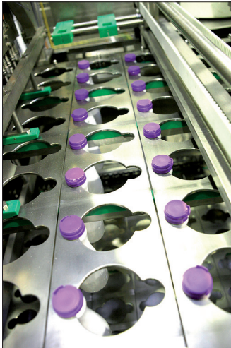
Mithilfe spezieller Zellenbretter können zwei verschiedene Neckdurchmesser gehandhabt werden
