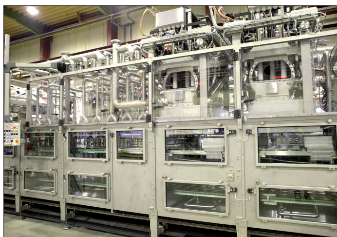
Gesamtansicht der für Unilever konzipierten Kunststoffflaschen-Füll- und Verschließmaschine "FF 5200-8/8" im Werk Ahaus kurz vor ihrer Auslieferung. Der Flaschensterilisations-Sektion (rechts) sind zwei Doseure nachgeschaltet.
