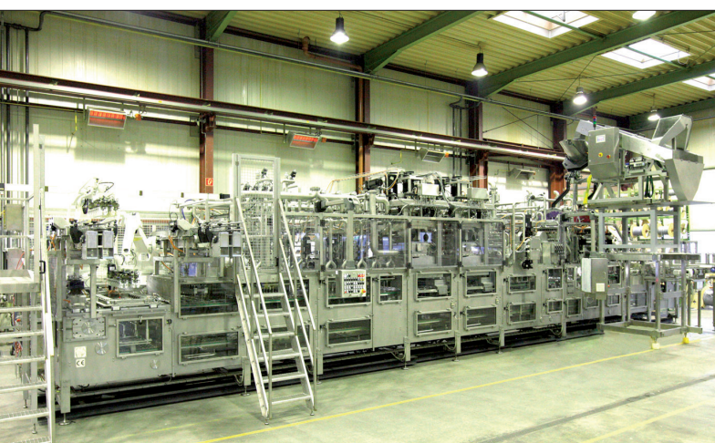
Gesamtansicht der für Unilever konzipierten Kunststoffflaschen-Füll- und Verschließmaschine "FF 5200-8/8" im Werk Ahaus kurz vor ihrer Auslieferung. Der Flaschensterilisations-Sektion (rechts) sind zwei Doseure nachgeschaltet.
