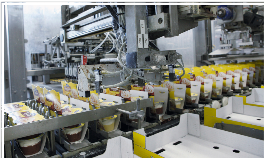
Drei in Reihe geschaltete Schmelzklebstoff-Auftragsköpfe des Typs MiniBlue II setzen je zwei Klebepunkte zur Fertigung von Steigen
