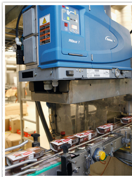
Die Auftragsköpfe werden durch automatische sensorgesteuerte Hotmelt-Befüllsysteme der ProBlue Fulfill-Baureihe gespeist
