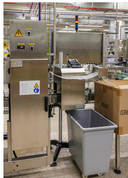
Die thermische Folienbehandlungseinheit (links) und die Objekterkennungs-Station
