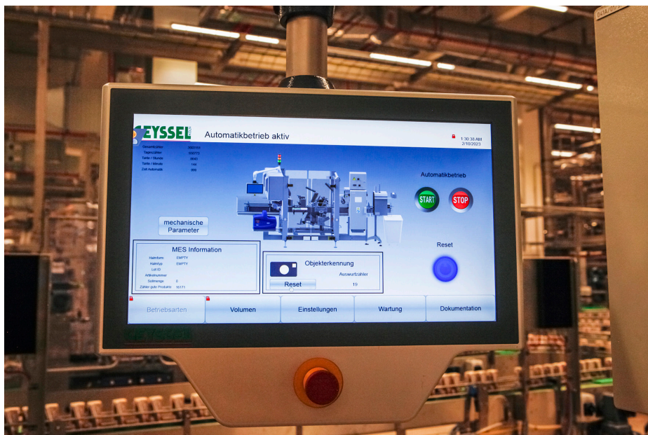
In das große, übersichtliche Touchscreen-Farbdisplay des Applikators ist auch die Steuerung der Folienbehandlung und der Objekterkennung integriert. (Fotos: Kimberly Wittlieb)
