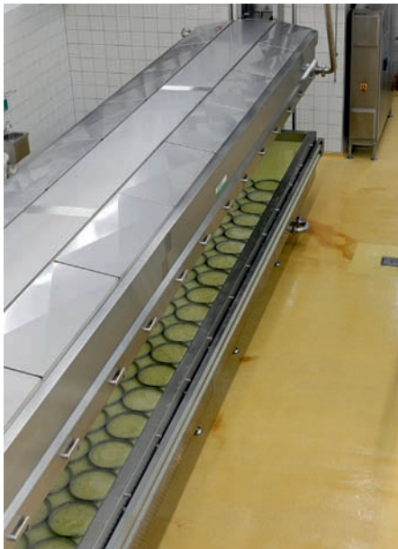
Über eine Direktleitung werden der Käsebruch und die Molke in die Formen gepumpt
