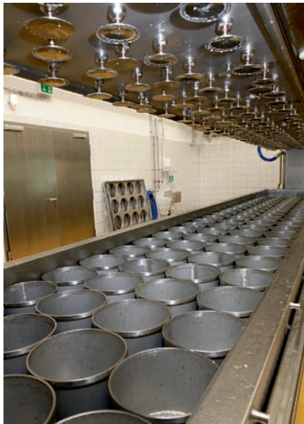
Je nach Schnittkäsesorte werden 30 cm oder 40 cm durchmessende Käseformen eingesetzt. Im Bild die erste Variante zur Herstellung von 5,5-kg-Laiben
