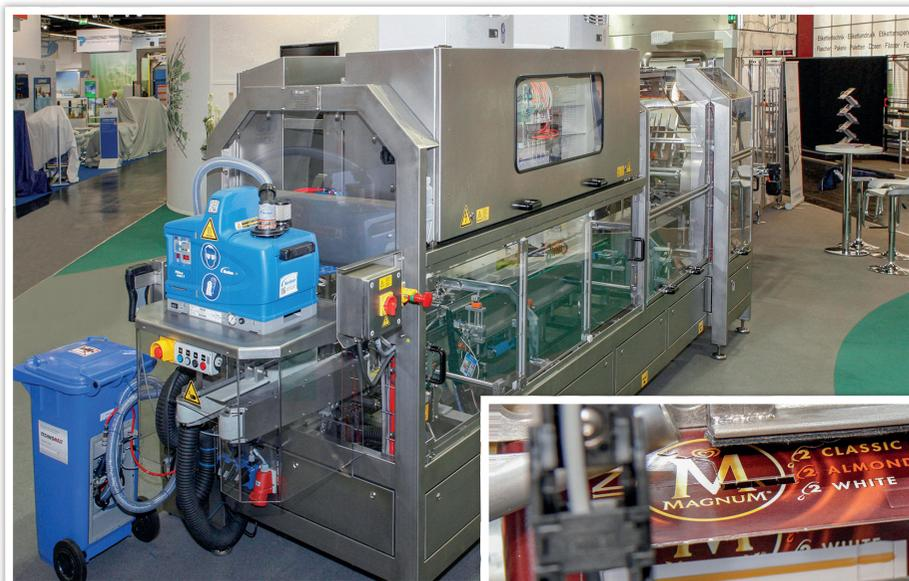
Der auf der FachPack 2015 vorgeführte Horizontalkartonierer HK 4 mit dem am Produktauslauf installierten Hotmelt-Auftragssystem ProBlue Liberty und der zugehörigen Schmelzklebstoff-Vorratsbehälter
