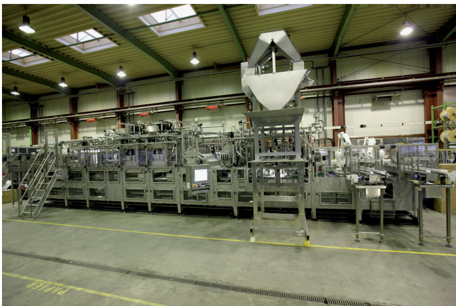
Gesamtansicht der für Unilever konzipierten Kunststoffflaschen-Füll- und Verschließmaschine FF 5200-8/8 im Werk Ahaus kurz vor ihrer Auslieferung (Foto: Kimberly Wittlieb)
