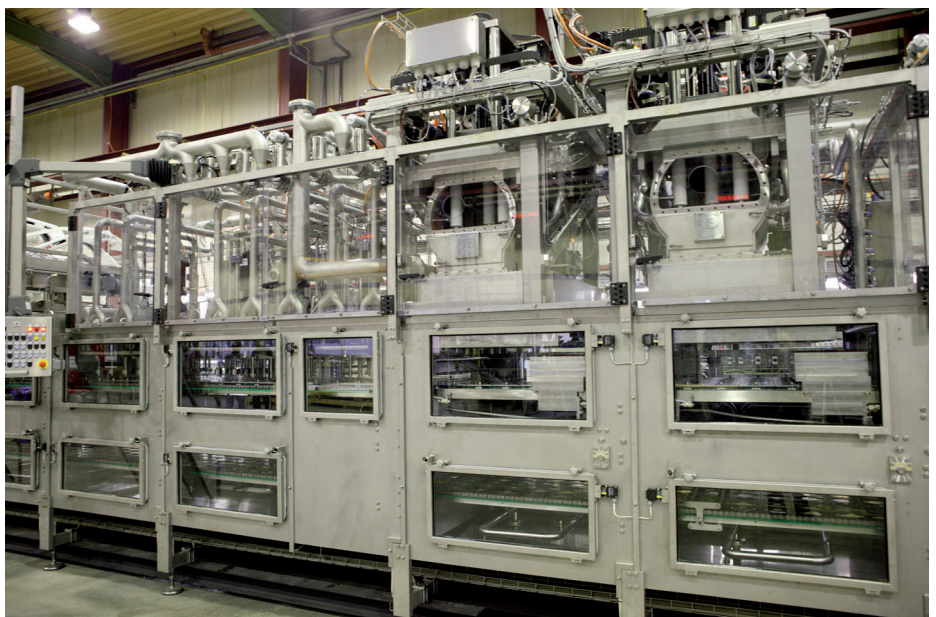
Der Flaschensterilisations-Sektion (links) sind zwei Doseure nachgeschaltet (Foto: Kimberly Wittlieb)
