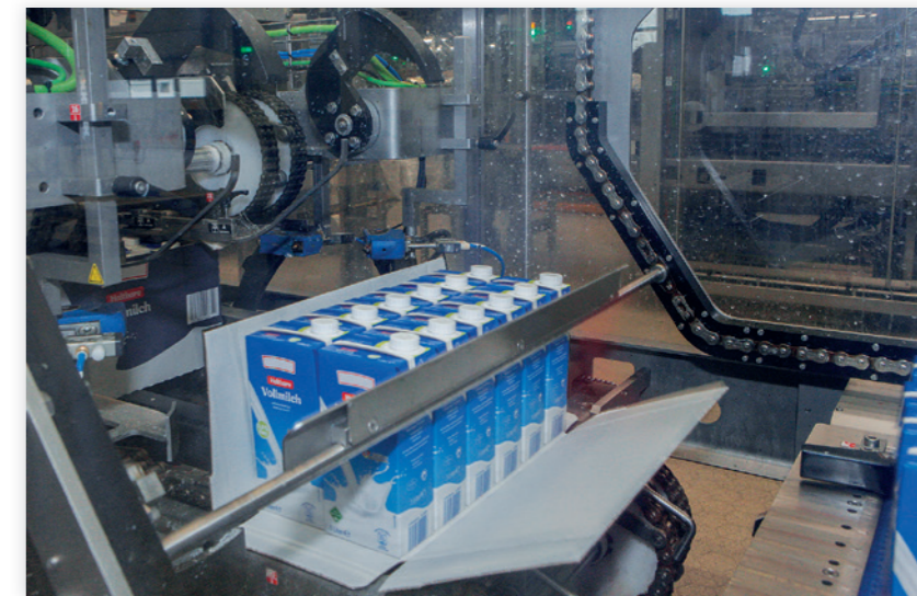
Die Tray-Verklebungsstation des Meurer-Kartonnierers (Foto: Kimberly Wittlieb)
