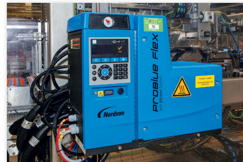
In Mechnich sind insgesamt 33 Schmelzklebstoff-Auftragsgeräte der ProBlue Flex-Baureihe von Nordson installiert (Foto: Kimberly Wittlieb)
