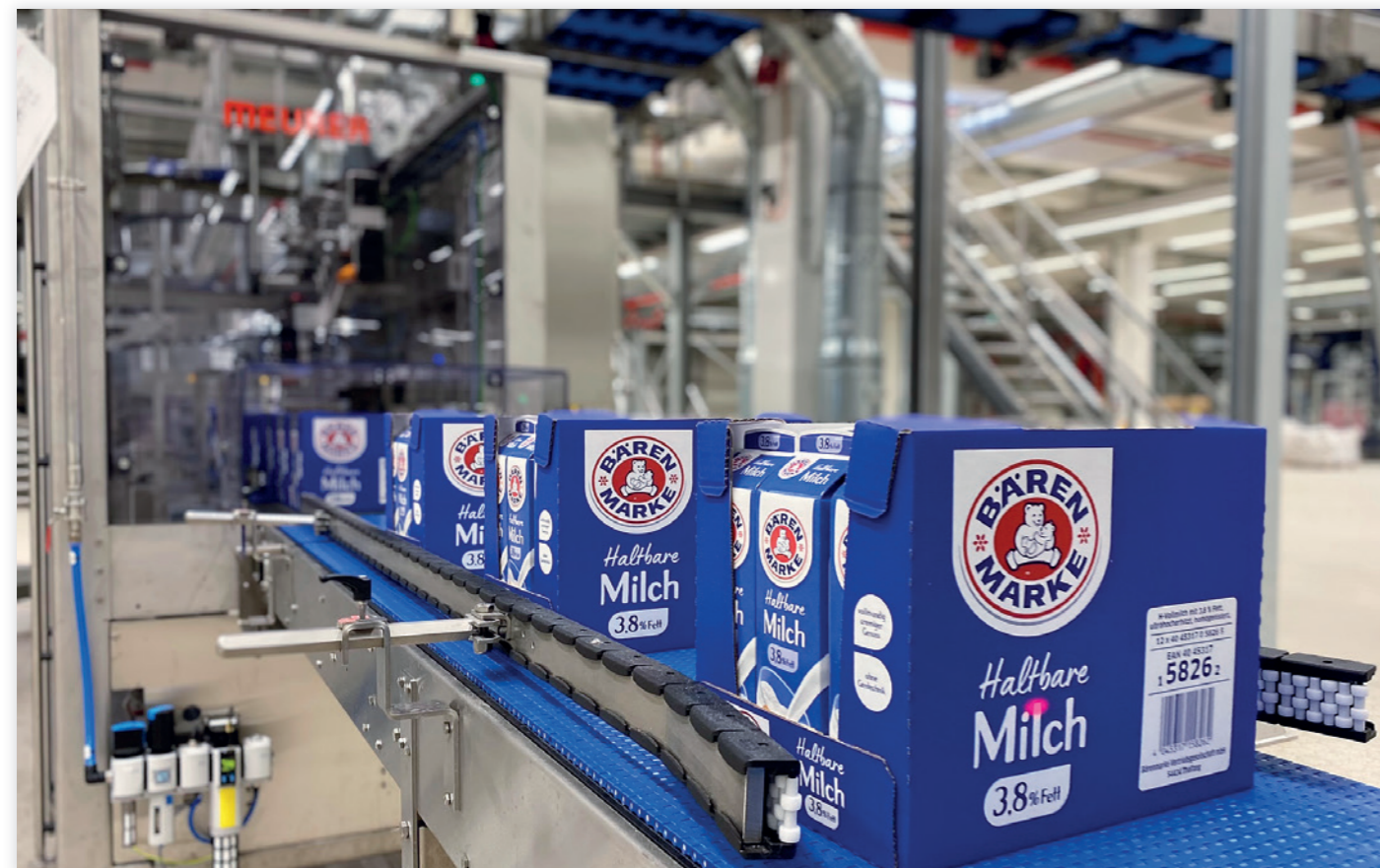
In Wrap around-Trays verpackte 12er-Gebinde auf dem Weg ins Hochregallager
