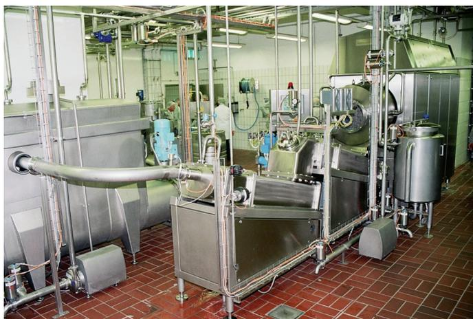
Gesamtansicht der GEA Westfalia-Butterproduktionsanlage. Links ist das Silo zur Zwischenlagerung zu erkennen
