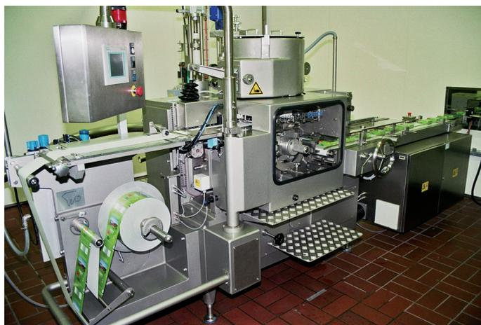
Mithilfe einer Ecopack FD 120 von Oystar Benhil erfolgt die Formung, Prägung und Verpackung der Butter
